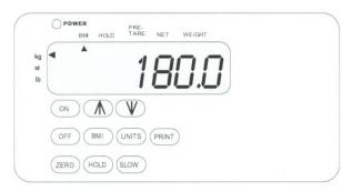
USING THE UP/DOWN ARROWS AND THE BMI BUTTON SET THE HEIGHT IN CM TO 180.0 AS SHOWN ON THE LEFT
